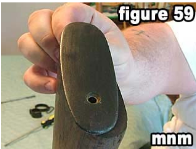
59) Reinstall the butt plate.
