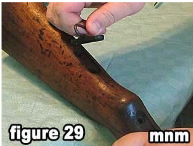
29) Remove the rear sling swivel .
