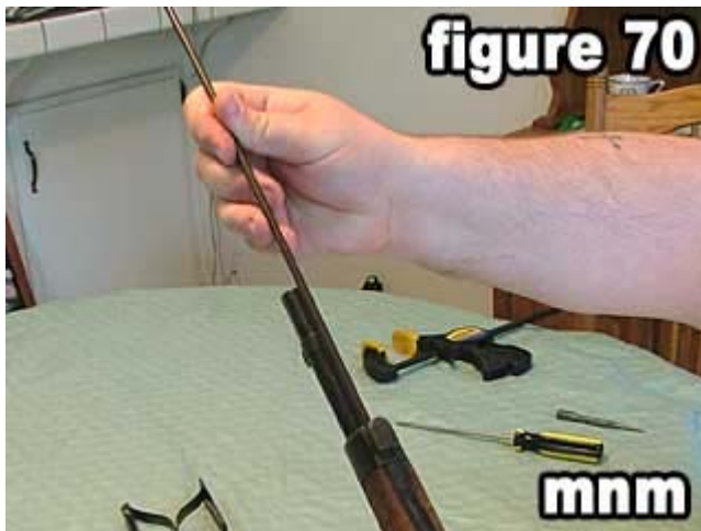
70) Insert cleaning rod .
