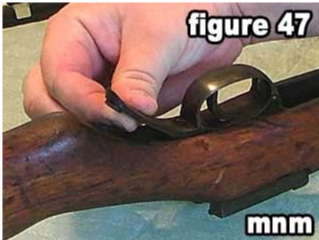
47) Reinstall the lower tang .
